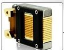
Микроканальный охлаждаемый диодный лазер
